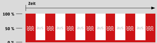
Leistungssteuerung durch Intervalle mit Standard-Mikrowellentechnologie. Beispiel: 50 % Leistung (ca. 450 Watt)
