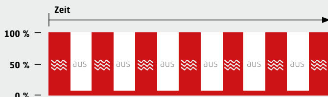
Leistungssteuerung durch Intervalle mit Standard-Mikrowellentechnologie. Beispiel: 50% Leistung (ca. 450 Watt)
